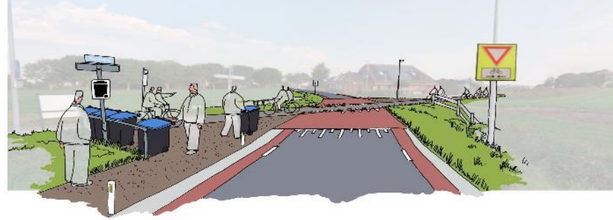
Impressie aansluiting wandelstrook van Dorpsweg op Stadsweg door duidelijke marking kruisingsvlak in kleur en met blokken, haaietanden, en bebording. Wandelstrook gemarkeerd met kleine reflectorpaaltjes tegen de betonstrook aan.
